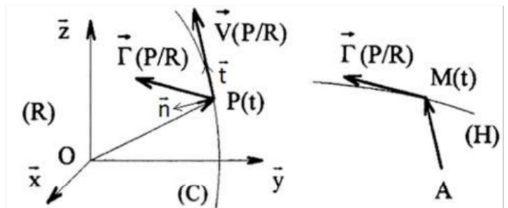
On a :  $\vec{\Gamma}_{P/R} = A(t) \cdot \vec{x} + B(t) \cdot \vec{y} + C(t) \cdot \vec{z}$  ; mais on peut aussi définir :  $\vec{\Gamma}_{P/R} = \gamma_t \cdot \vec{t} + \gamma_n \cdot \vec{n}$
