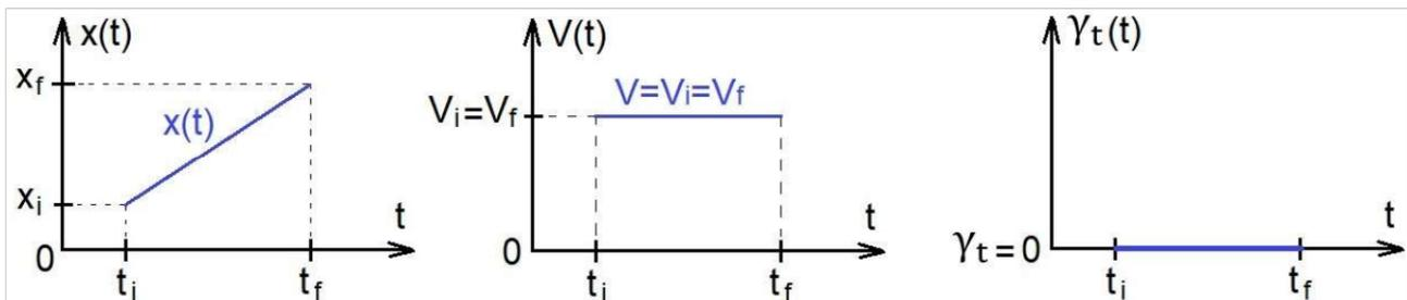
Ce sont les équations et les graphiques caractéristiques par exemple d'une voiture (modélisée par un point) qui se déplace en ligne droite à vitesse constante.
