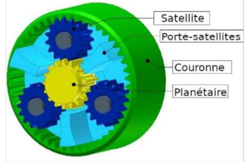
Pour un observateur lié au porte-satellite, tous les axes géométriques des roues sont fixes. Par conséquent, on se ramène au cas précédent, du réducteur simple, en considérant les vecteurs vitesse de rotation des arbres d'entrée et de sortie par rapport au porte-satellite. Soit :
