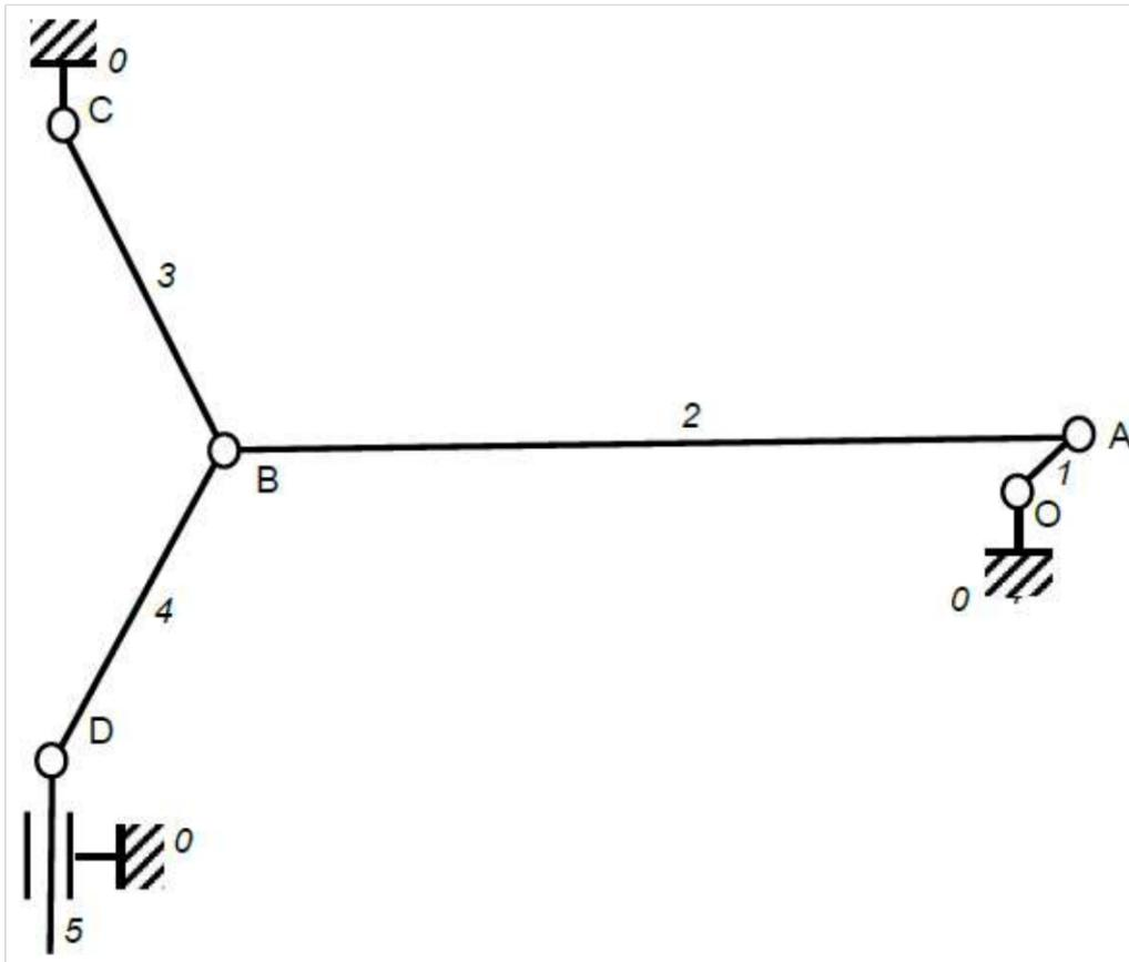
4 – Tracer maintenant les vecteurs vitesses  $\vec{V}(A \in 1/0)$ ,  $\vec{V}(A \in 2/0)$ ,  $\vec{V}(B \in 2/0)$ ,  $\vec{V}(B \in 4/0)$ ,  $\vec{V}(D \in 4/0)$  et  $\vec{V}(D \in 5/0)$  sur le schéma suivant en utilisant l'équiprojectivité.
