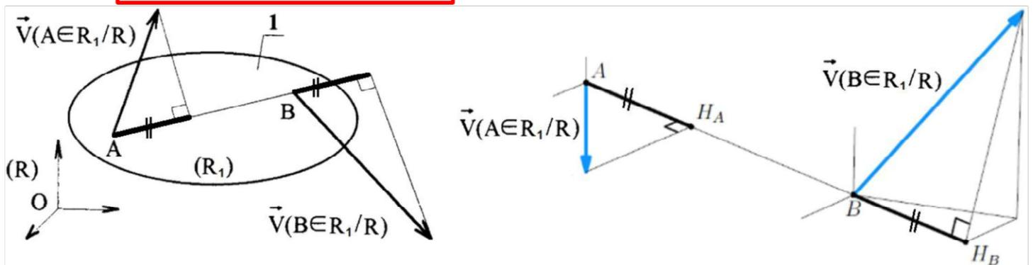
Cela signifie que, sur un axe de direction AB, les mesures algébriques des projections orthogonales des vecteurs vitesse des points A et B sont égales. C'est logique : les points A et B doivent se suivre dans le mouvement du solide 1 par rapport au repère R sinon le solide éclaterait. Cette relation, valable dans le plan mais aussi dans l'espace est surtout utilisée dans la résolution graphique des problèmes de cinématique plane.
