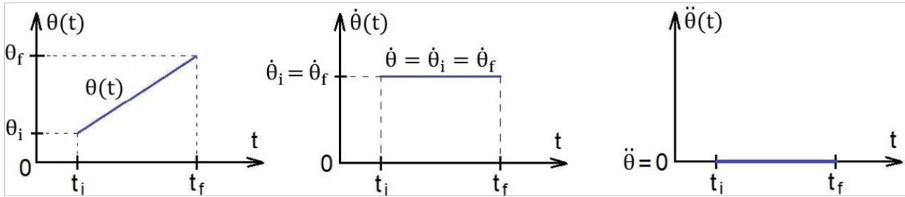
Ce sont les équations et les graphiques caractéristiques par exemple d'un cheval en bois sur un manège (modélisée par un point) qui se déplace en rotation autour d'un axe à vitesse constante.
