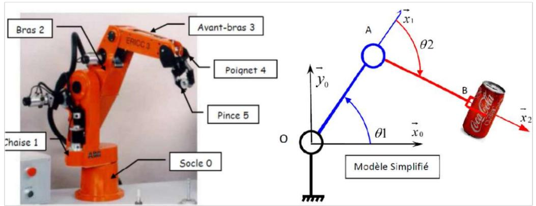
On rappelle les résultats trouvés pour le modèle géométrique :  $\vec{OB} = \vec{OA} + \vec{AB} = L \cdot \vec{x}_1 + L \cdot \vec{x}_2$  et dans  $R_0$  :
