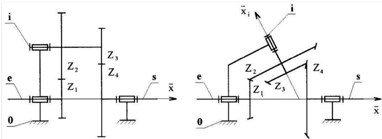
Un sens de parcours de la chaîne cinématique étant fixé au niveau des engrenages, on note e l'arbre d'entrée, s l'arbre de sortie, i l'arbre lié aux roues intermédiaires et  $Z_1, Z_2, Z_3, Z_4$  les nombres de dents des roues.
