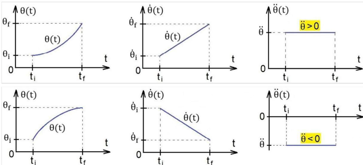
Ce sont les équations et les graphiques caractéristiques par exemple de la phase de mise en mouvement (ou en arrêt) d'un cheval en bois sur un manège (modélisée par un point) qui se déplace en rotation autour d'un axe.
