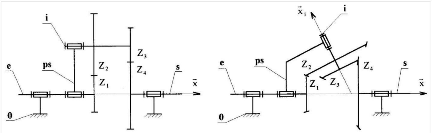
Un sens de parcours de la chaîne cinématique étant fixé au niveau des engrenages, on note e l'arbre d'entrée, s l'arbre de sortie, i le satellite et  $Z_1, Z_2, Z_3, Z_4$  les nombres de dents des roues.
