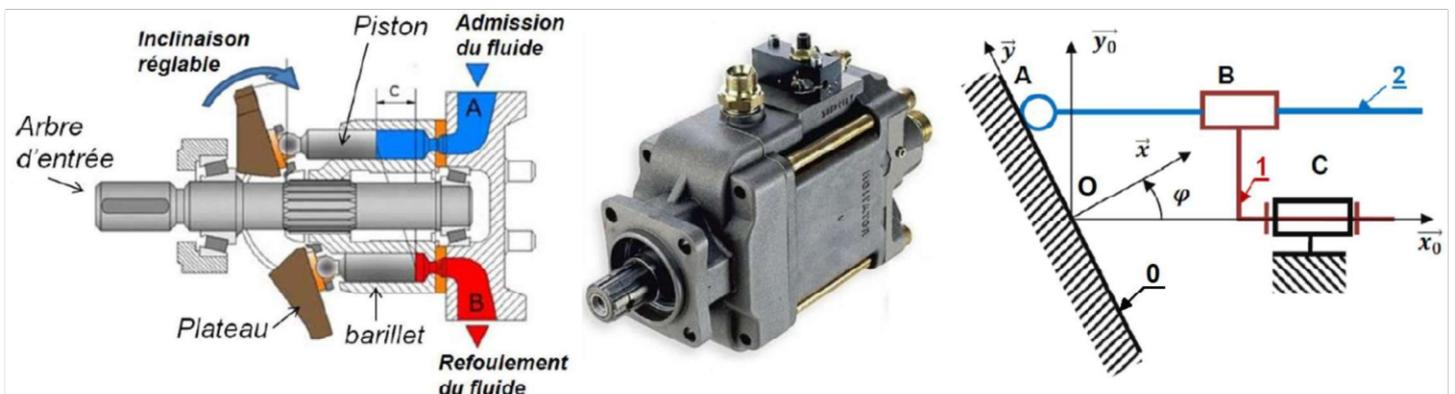
Soient  $R_0(O, \vec{x}_0, \vec{y}_0, \vec{z}_0)$  et  $R(O, \vec{x}, \vec{y}, \vec{z}_0)$  associés au corps 0, tels que  $\vec{OC} = c \cdot \vec{x}_0$  et  $\varphi = (\vec{x}_0, \vec{x}) = cte$ .
