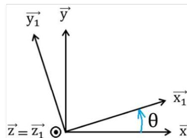
Propriétés du vecteur rotation :  $\vec{\Omega}(R_2/R_1) = -\vec{\Omega}(R_1/R_2)$  et  $\vec{\Omega}(R_n/R_1) = \sum_{i=2}^n \vec{\Omega}(R_i/R_{i-1})$
