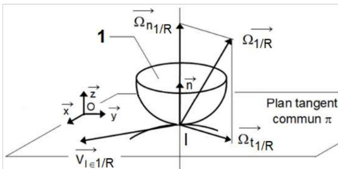
Dans le cas d'un contact sans glissement, on a :  $\vec{V}(I \in 1/R) = \vec{0}$  (CRSG : condition de roulement sans glissement). C'est par exemple le cas d'une roue sur le sol qui roule sans glisser ou dans le cas d'un engrenage.
